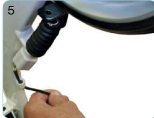
5 Ziehen Sie den Bremszug aus der Kabelverstellungsschraube und der Feder heraus.
