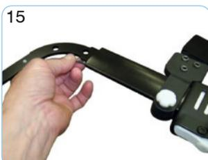
15 Schieben Sie den neuen Bremszug nach unten, bis er im Kabelloch unten am Rahmen sichtbar wird.
