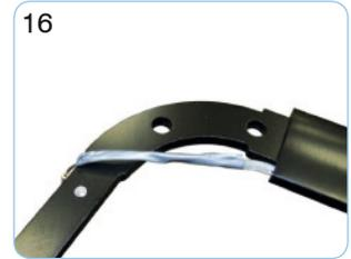
Entfernen Sie die Schnur von der alten Bremse und kleben Sie die Schnur an den Bremszug der neuen Bremse. Kleben Sie die Schnur nicht an die Kabelhülle. Der beklebte Bereich darf nicht dicker sein als die Kabelhülle.
