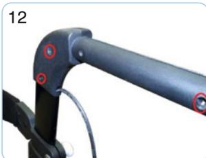
12 Drehen Sie die drei Schrauben, die den Handgriffhalter am Handgriffrahmen befestigen mit Hilfe des Kreuzschlitzschraubendrehers heraus. Trennen Sie die beiden Hälften des Bremsgriffs voneinander, um sie von der Griffstange abzunehmen.
