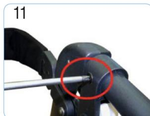
Drehen Sie die Schraube, die den Bremsgriff an der Griffstange befestigt, mit Hilfe eines Kreuzschlitzschraubendrehers heraus. Nehmen Sie den Bremsgriff ab.
