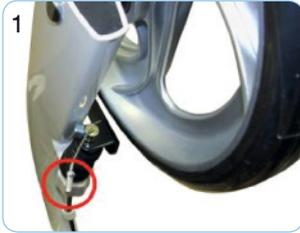
1 Entfernen Sie die Kabelendhülse am Bremszug.
