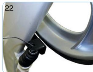
Schieben Sie den Bremszug durch die Kabelverstellungsschraube und die Feder.
