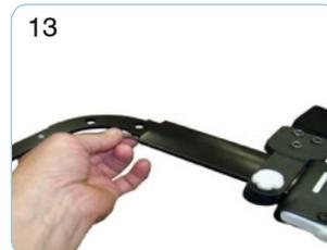
13 Ziehen Sie den Bremszug nach oben und führen Sie ihn durch das Loch unten im Rahmen. Ziehen Sie so lange, bis er aus dem Rahmen austritt.
