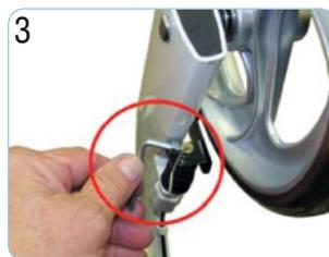
Lösen Sie die Kabelbefestigung mit einem 4 mm Inbusschlüssel und nehmen Sie sie ab.
