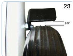
Schieben Sie die Kabelbefestigung auf den Bremszug, bis zwischen Bremsbacke und Rad ein Abstand von etwa 3 mm entsteht.
