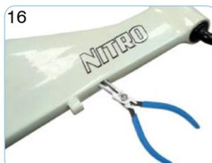
16 Fassen Sie den Bremszug mit einer langen, dünnen Spitzzange durch das Kabelloch und ziehen Sie ihn aus dem Rahmen heraus.
