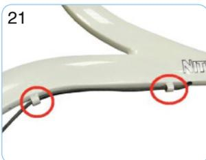
Schieben Sie den Bremszug durch die beiden unteren Bremszugführungen.
