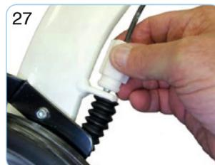
Regulieren Sie die Bremse gegebenenfalls anhand der Kabelverstellungsschraube. Kann die Bremse nicht so eingestellt werden, dass sie das Rad abbremst, lösen Sie die Kabelbefestigung und bringen Sie sie in die benötigte Position.
