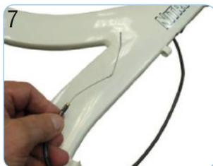
Befestigen Sie ein etwa 150 cm langes Stück Schnur oder Kabel mit Klebeband möglichst am gesamten Bremszug. Kleben Sie die Schnur nicht an die Kabelhülle. Der beklebte Bereich darf nicht dicker sein als die Kabelhülle.
