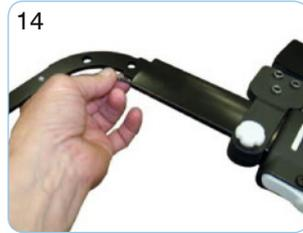
Ziehen Sie dem Bremszug nach oben und führen Sie ihn durch das Loch unten im Rahmen. Ziehen Sie so lange, bis er aus dem Rahmen austritt. Achten Sie darauf, dass die Schnur nicht in den Rahmen hineingezogen wird.
