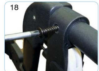
18 Schieben Sie den Bremsgriff auf den Griffhalter. Während Sie die Bremse weiter schieben, ziehen Sie am Bremszug, der unten aus dem Rahmen kommt. Schrauben Sie den Bremsgriff fest.
