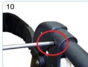
10 Drehen Sie die Schraube, die den Bremsgriff an der Griffstange befestigt, mit Hilfe eines Kreuzschlitzschraubendrehers heraus. Nehmen Sie den Bremsgriff ab.
