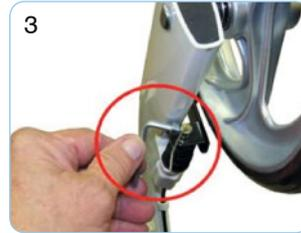
3 Lösen Sie die Kabelbefestigung mit einem 4 mm Inbusschlüssel und nehmen Sie sie ab.
