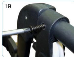
Schieben Sie den Bremsgriff auf den Griffhalter. Während Sie die Bremse weiter schieben, ziehen Sie am Bremszug, der unten aus dem Rahmen kommt. Schrauben Sie den Bremsgriff fest.
